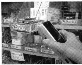
薬剤師がバーコードをスキャンし、システムで処方せんの入力データと照合する。異なる場合は警告が出る。
